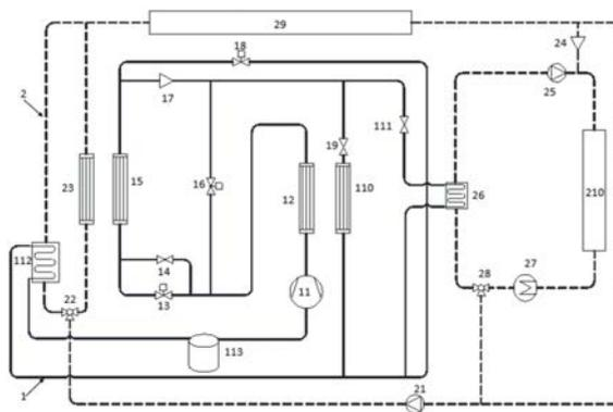
1. 一种集成直接式热泵的整车热管理系统,其特征在于,包括制冷剂系统(1)和冷却液系统(2);
