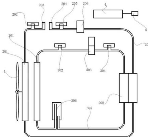
1. 一种汽车集成式热管理机组,其特征在于,包括电动空调压缩机、电子水泵、空调冷凝器、机组控制器、水氟换热器、散热水箱、电子风扇、温度传感器、压力传感器和冷媒干燥器膨胀阀总成。
